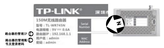
3.个人电脑的 IP 属性中 IP 地址必须和路由器的管理 IP 在同一个网段,只要最后的数字不同即可(如果相同,会提示 IP 冲突)。本例中设为 192.168.1.10。
